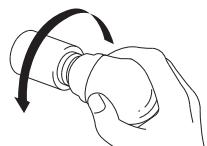
④外したときと逆の手順でLED電球・蛍光ランプを取り付け、照明カバーを取り付けます。
