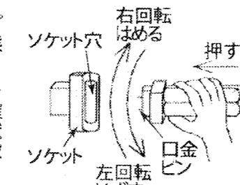
②取付けはランプの口金ピンをソケット穴に合わせ奥まで確実に差し込む。押し込んだ状態でランプを右に回転させ取付ける。(回転角約15°)
