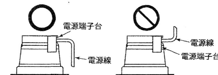
○電源線は上図のように電源端子台より天井面側へ向かって折り曲げてください。
