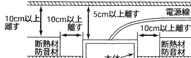
電源線は、断熱材・防音材の上側にくくるようにしてください。
