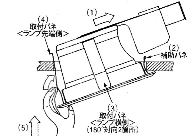
○器具本体が天井裏の障害物に接触し取付けできない場合、下図のとおり本体を回して動かし、障害物を回避し取付けることが可能ですが。（但し、本体90°回転時は埋込深さ170mm以上必要です。）
