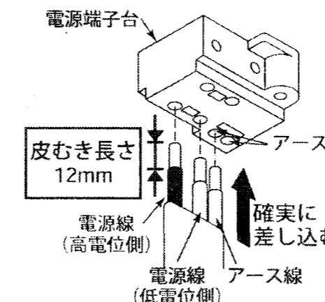
電源線接続の速結端子の電源線を取り外すときは、幅6mmのマイナスドライバーを、はずし穴にまっすぐ差し込んでください。
