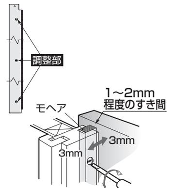
● ⊕ドライバーを使用して、調整部3か所を回転させて調整します。
