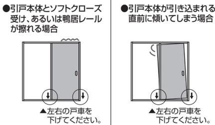
● 調整ねじの部分を⊕ドライバーを使用して調整してください。
